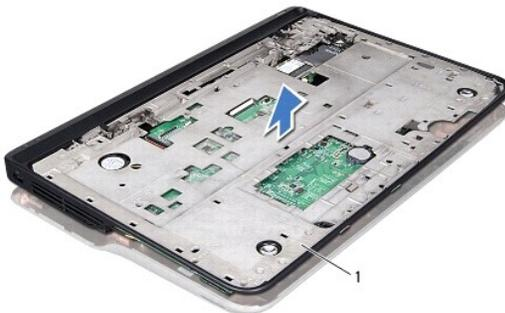
1 Ensamblaje de la cubierta superior
